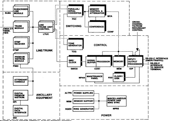
SHADED BLOCKS DENOTE OPTIONAL DUPLEX COMMON CONTROL DOTTED LINES DENOTE CONNECTION TO REDUNDANT COMMON CONTROL
