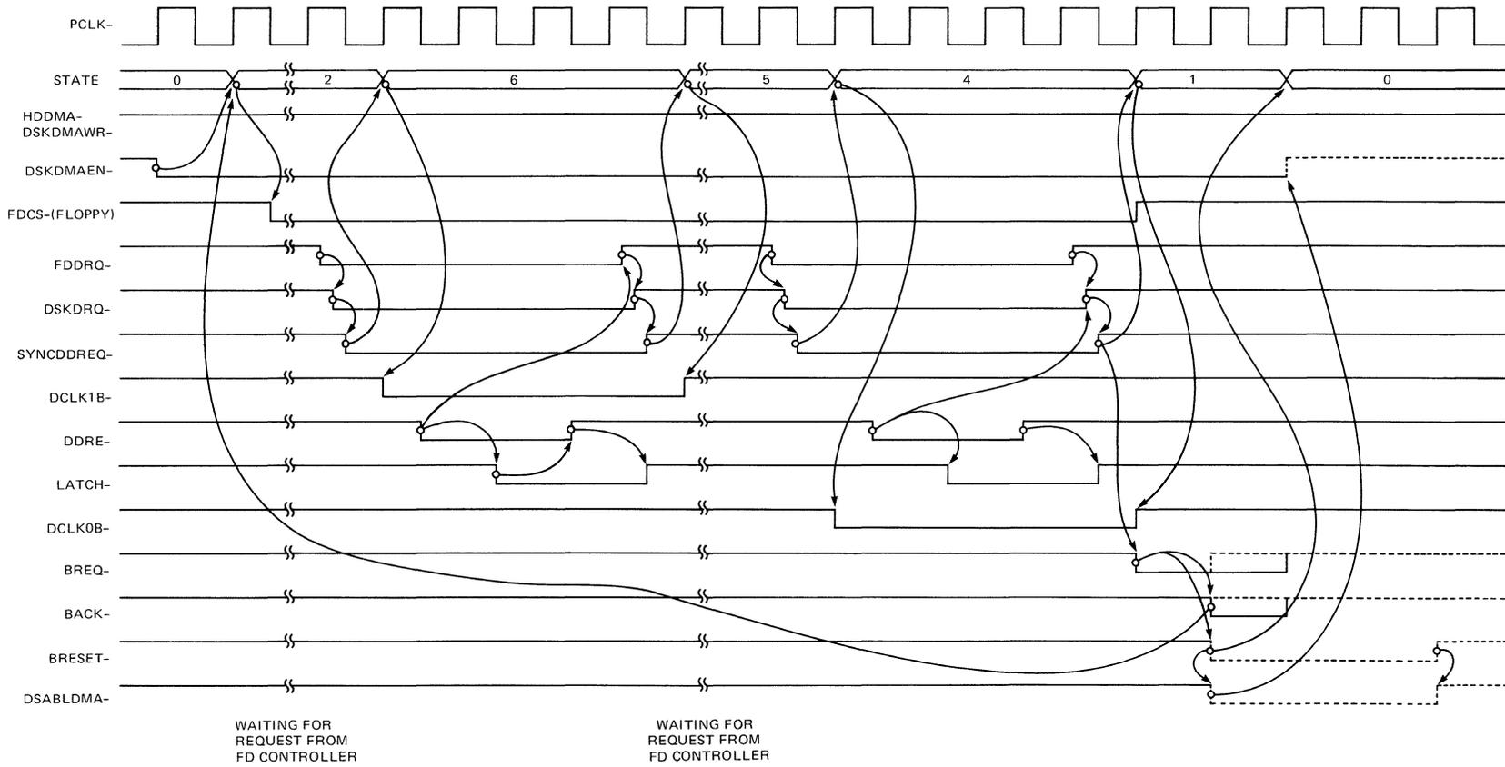
Figure 6-7. Disk Byte State Machine -- Floppy Disk Read
