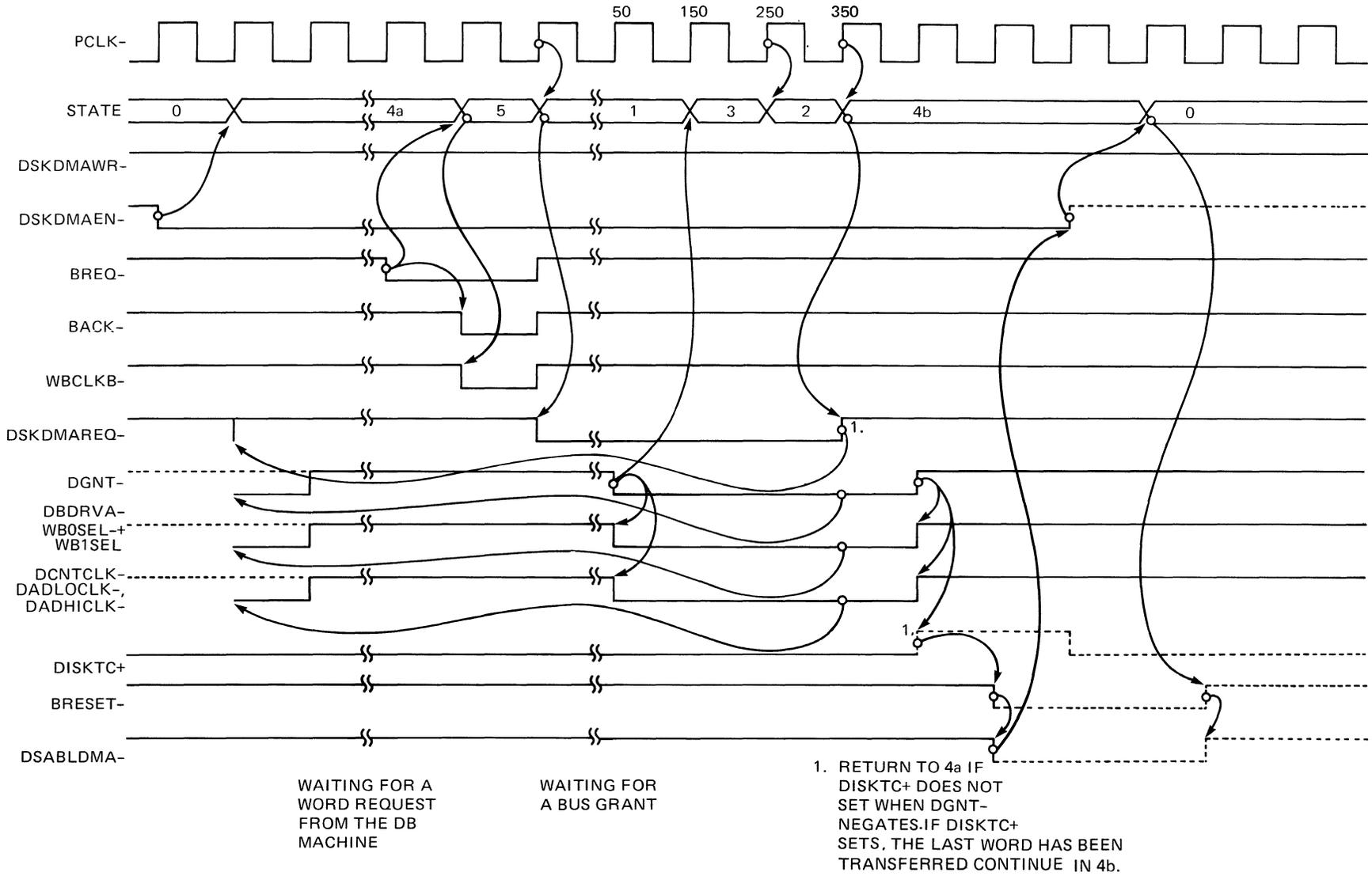
Figure 6-9. Disk Word State Machine -- DMA Disk Read
