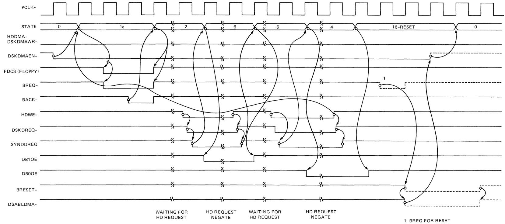
Figure 6-6. Disk Byte State Machine -- Hard Disk Write
