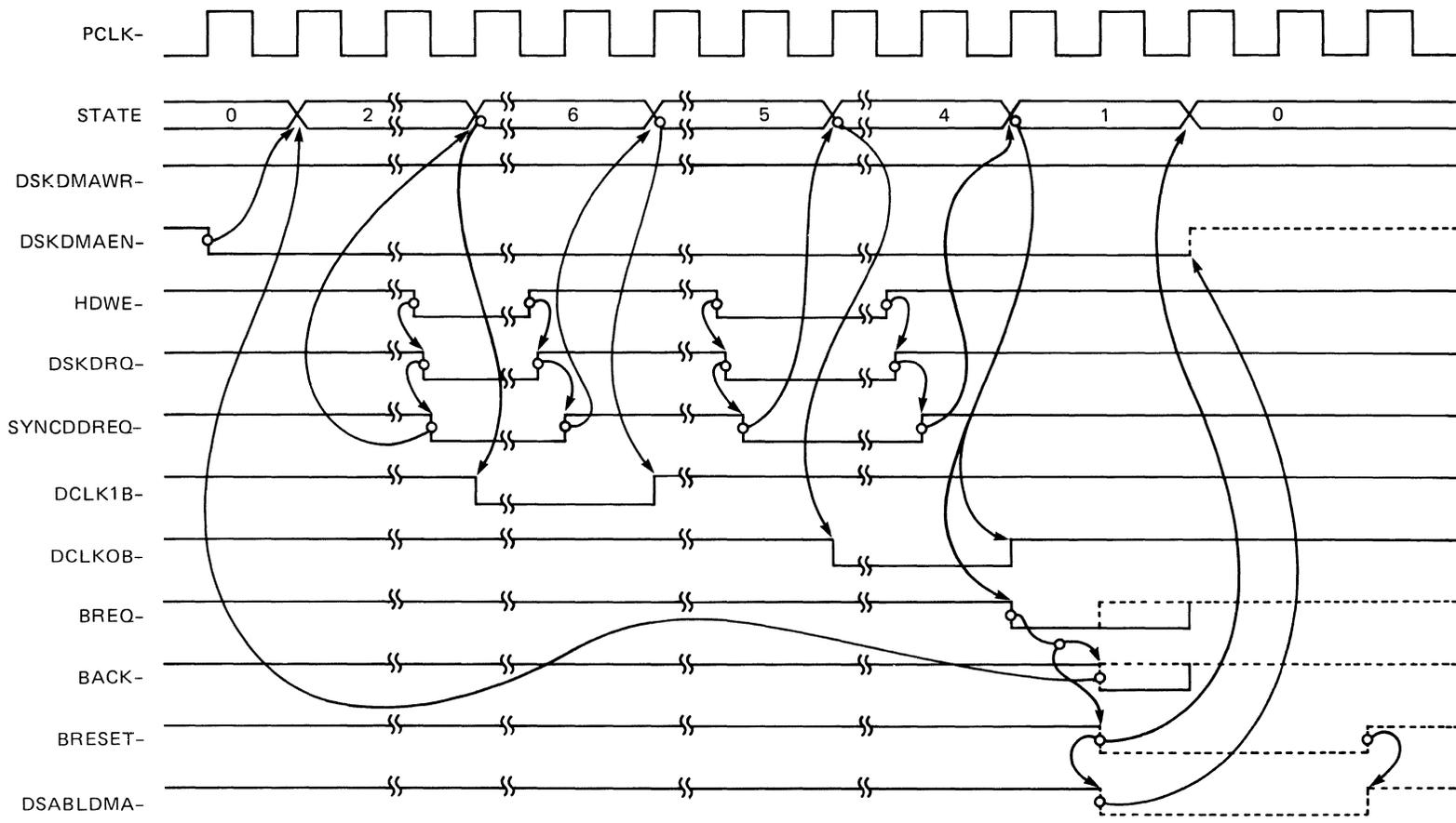
Figure 6-8. Disk Byte State Machine -- DMA Hard Disk Read
