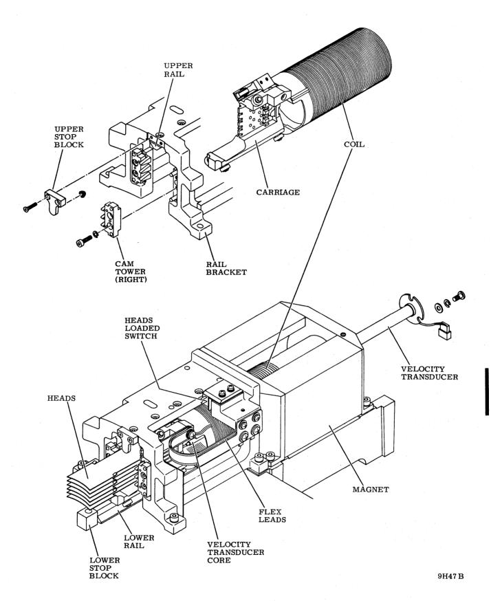
Figure 3-8. Actuator Components
