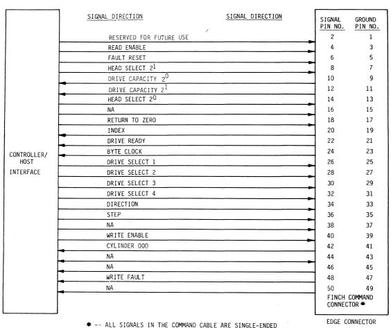
◆ -- ALL SIGNALS IN THE COMMAND CABLE ARE SINGLE-ENDED SIGNALS.
