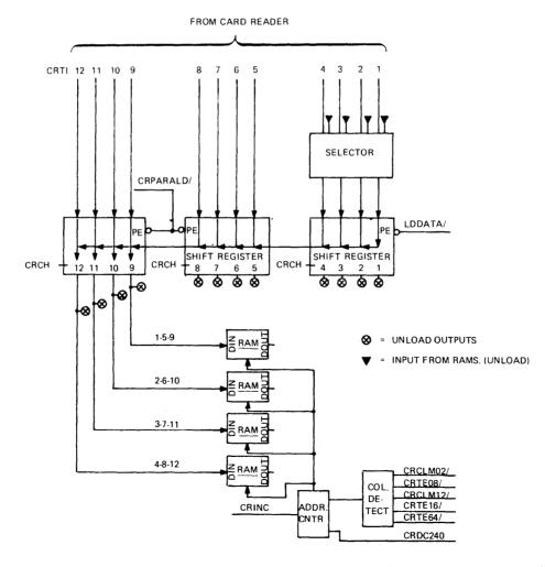
Fig. II-1 BUFFER LOAD OPERATION
