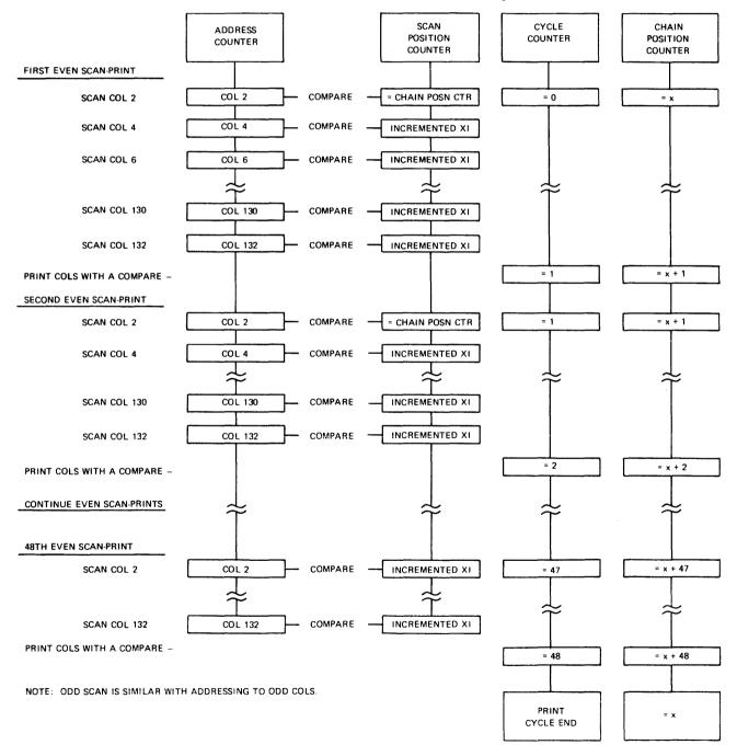
Fig. II-2 400 - LPM EVEN SCAN OPERATION
