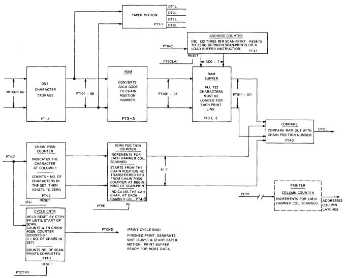
Fig. II-1 B0244 IOC BLOCK DIAGRAM
