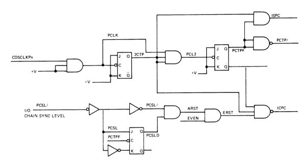
Fig. II-4 CLOCK CIRCUIT
