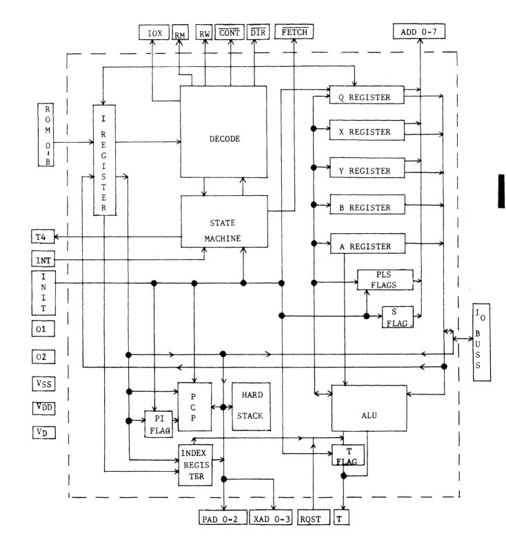
FIG. IIC-118 BLOCK DIAGRAM TPU LSIC
