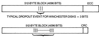
TYPICAL DROPOUT EVENT FOR 1/4-IN. CARTRIDGE TAPE = 130 BITS
