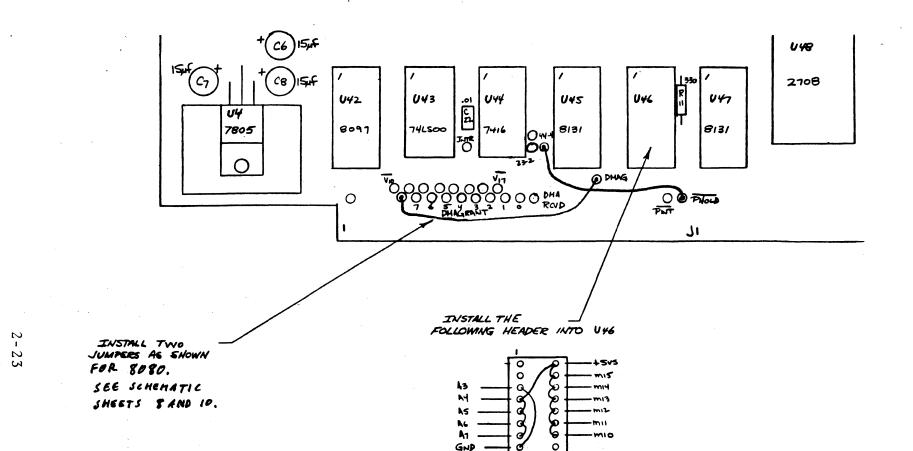
JUMPER TO GND FOR "O" JUMPER TO +SVS FOR "1"
