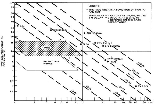
POWER DISSIPATION IN MW/GATE
