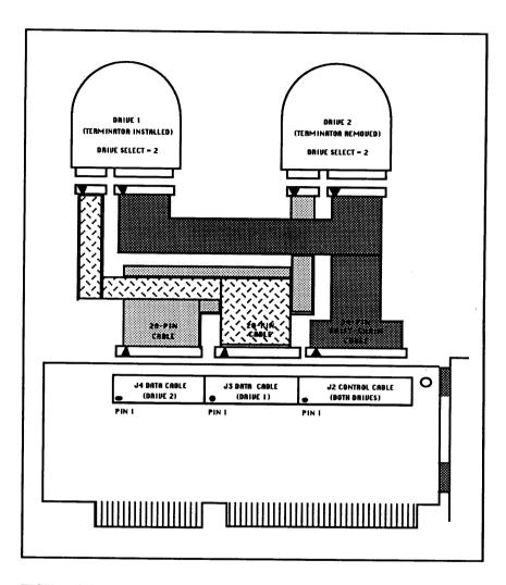
FIGURE 2-3. ACB-2372 CONTROLLER AND DRIVE CABLING-TWISTED CABLE (HARD DISK CABLES)
