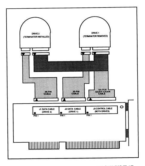
FIGURE 2-6. ACB-2370 CONTROLLER AND DRIVE CABLING-FLAT CABLE (HARD DISK CABLES)
