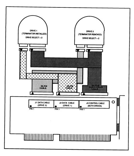
FIGURE 2-5. ACB-2370 CONTROLLER AND DRIVE CABLING-TWISTED
