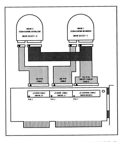
FIGURE 2-4. ACB-2372 CONTROLLER AND DRIVE CABLING-FLAT CABLE (HARD DISK CABLES)
