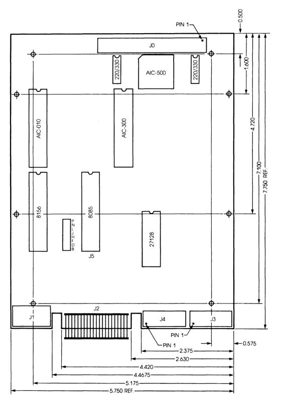
FIGURE 1-1. ACB-4520A BOARD LAYOUT
