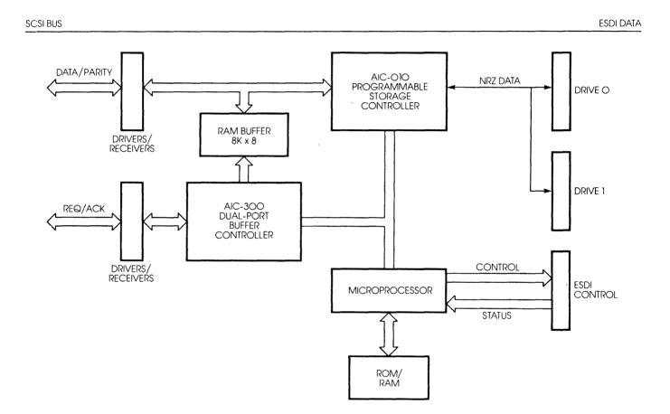
FIGURE 2-1. ACB-4520A BLOCK DIAGRAM
