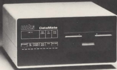
DataMate smart RS232 mini floppy.
