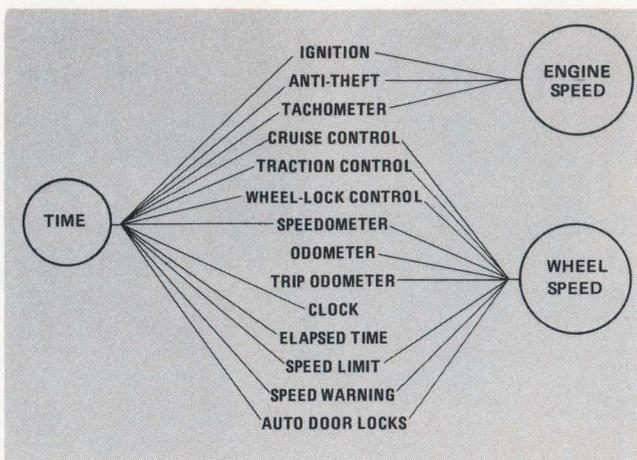
Fig. 2. Computer Subsystem Chart
