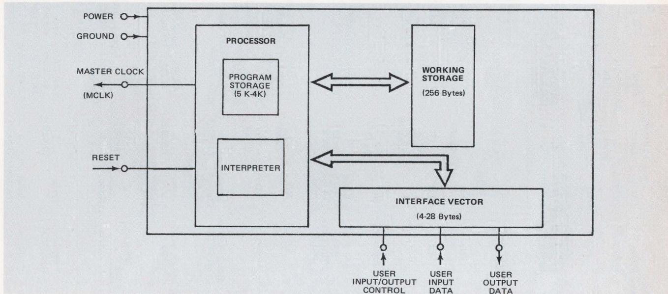
Fig. 3. SMS Microcontroller
