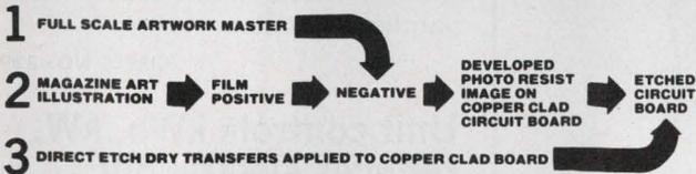
**NO CAMERA DARKROOM FILM CUTTING TRACING** USES DATAK'S POS-NEG PROCESS
