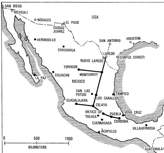
Figure 1 - Teléfonos de México 4-gigahertz radio-relay network, 1962/1965.
