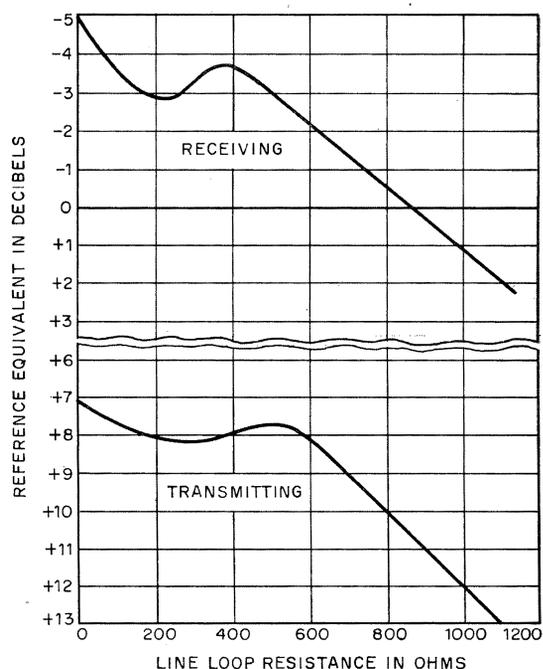
Figure 6—Volume rating of Deltaphone based on the Nouveau Système Fondamental pour la détermination des Équivalents de Référence. Operation is with 50 volts over a 200+200-ohm feed with cable of 24 American wire gauge.
