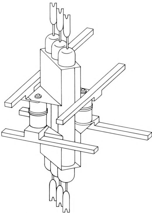
Figure 6—Latching crosspoint element of Le Matériel Téléphonique using 3 type *H 50* reed contacts.
