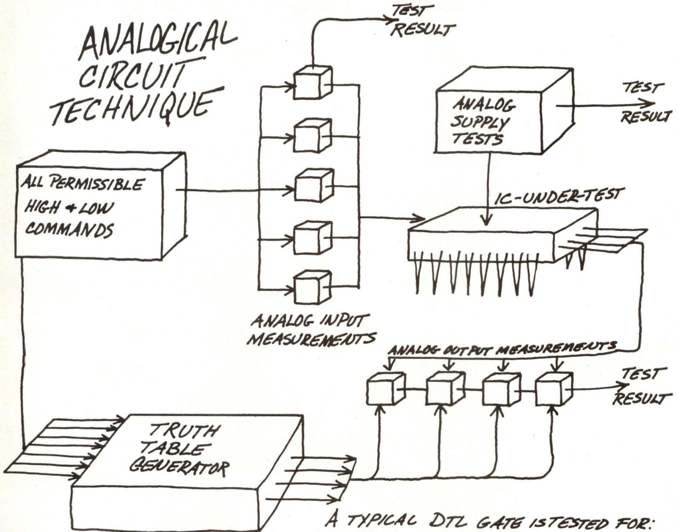
A TYPICAL DTL GATE IS TESTED FOR:
