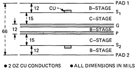
(a) NOTATION FOR INTERLAYER CROSSTALK ON THE EXTENDER BOARD.
