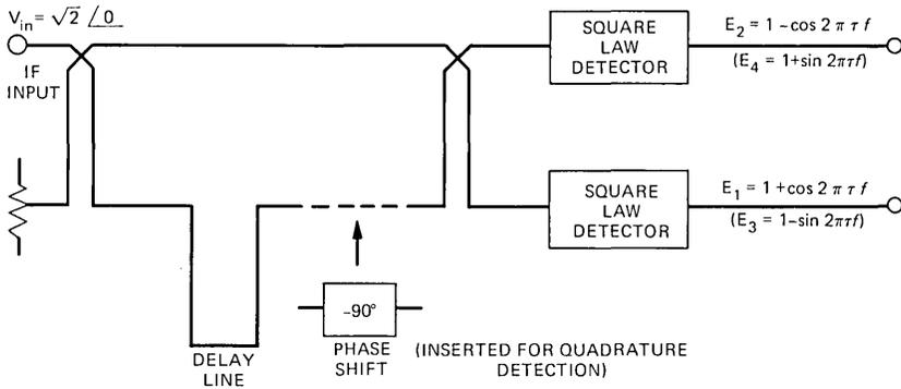
Fig. 11—Delay-line detector.
