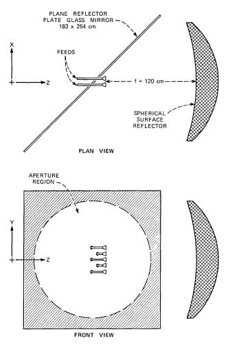
Fig. 1—Multibeam antenna.
