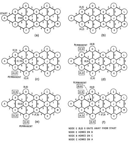
Fig. 4—Dijkstra minimum-distance algorithm.
