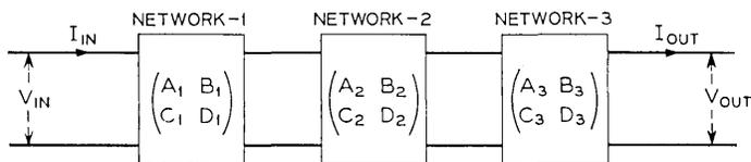
$$\begin{bmatrix} A & B \\ C & D \end{bmatrix}_{\text{overall}} = \begin{bmatrix} A_1 & B_1 \\ C_1 & D_1 \end{bmatrix} \cdot \begin{bmatrix} A_2 & B_2 \\ C_2 & D_2 \end{bmatrix} \cdot \begin{bmatrix} A_3 & B_3 \\ C_3 & D_3 \end{bmatrix} \quad (4)$$
