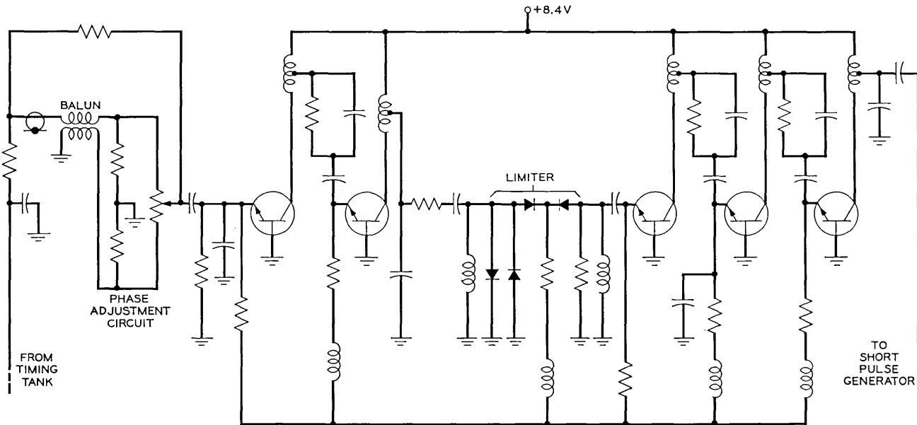
Fig. 28—Timing amplifier circuit.
