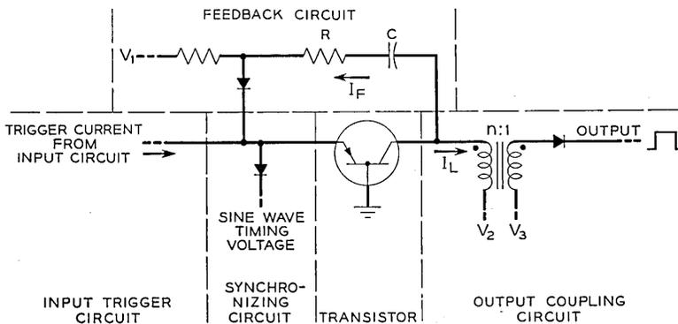
Fig. 5 — RC feedback amplifier.
