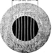
0.8 MIL DIA TUNGSTEN WIRE GRID BRAZED TO DIAPHRAGM
