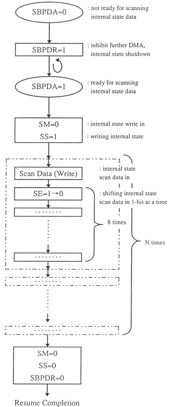
N=28 byte (Total Scan Data=218 bit(27 byte × 8+2bit))
