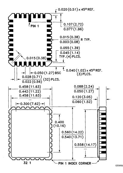
32-PAD CERAMIC LEADLESS CHIP CARRIER PACKAGE TYPE E
