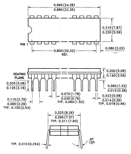
**18-LEAD HERMETIC DUAL IN-LINE PACKAGE TYPE D**
