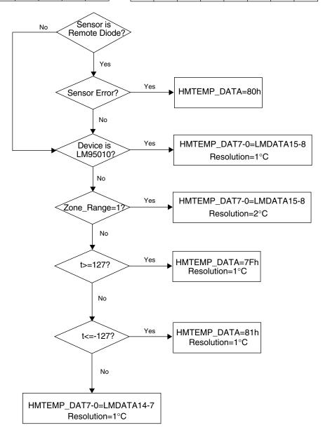
t = numerical value of LM96011/LM96010/LM96012 format temperature data
