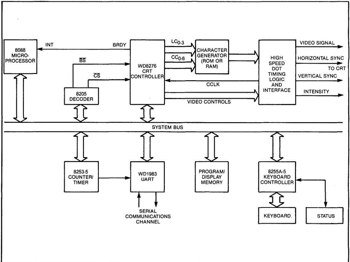
Figure 3. CRT SYSTEM BLOCK DIAGRAM
