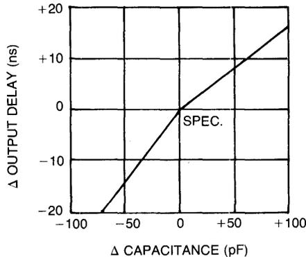
Figure 3 OUTPUT DELAY vs CAPACITANCE
