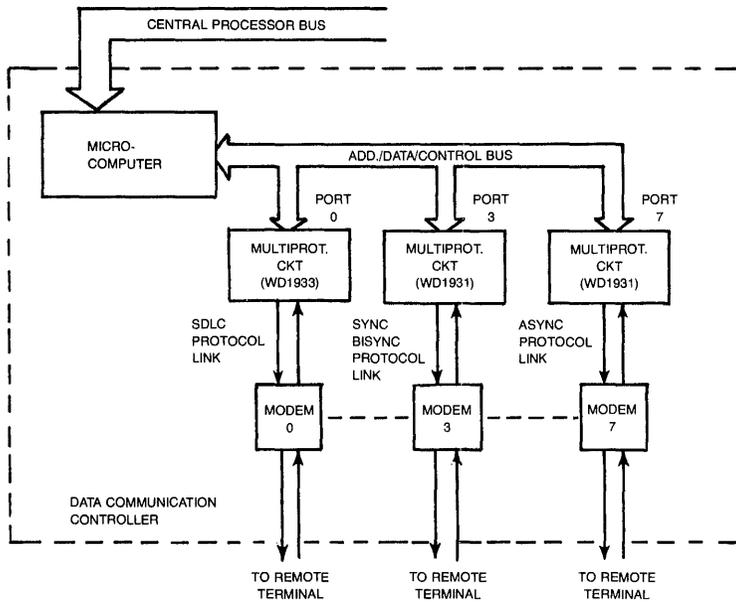
Figure 6. DATA COMMUNICATION CONTROLLER
