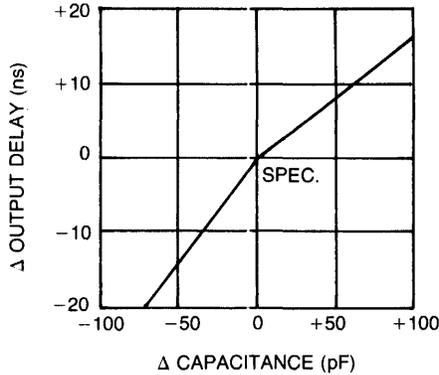
Figure 3 OUTPUT DELAY VS CAPACITANCE
