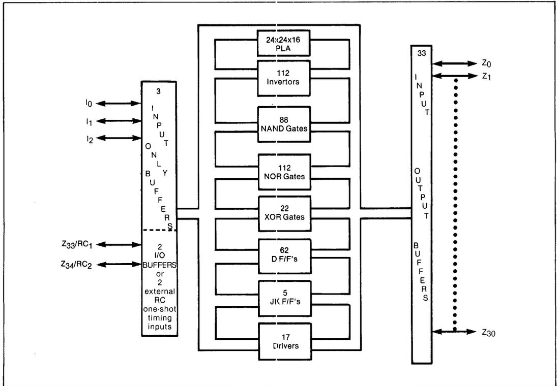
**Figure 2 WD1840 BLOCK DIAGRAM**
