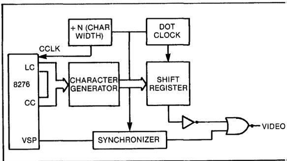
Figure 14. TYPICAL DOT LEVEL BLOCK DIAGRAM
