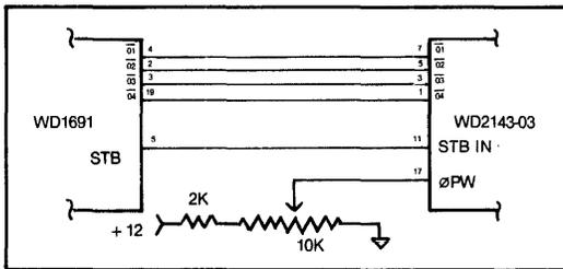
Figure 2 WRITE PRECOMP OPERATION WITH F.S.L. WD1691
