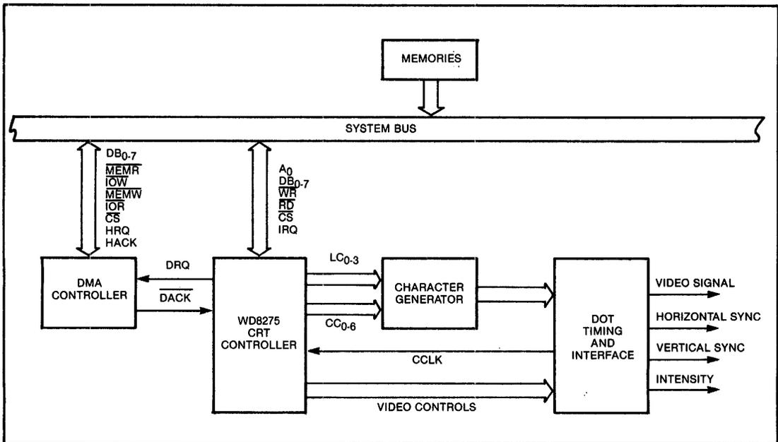
Figure 5. WD8275 SYSTEMS BLOCK DIAGRAM SHOWING SYSTEMS OPERATION
