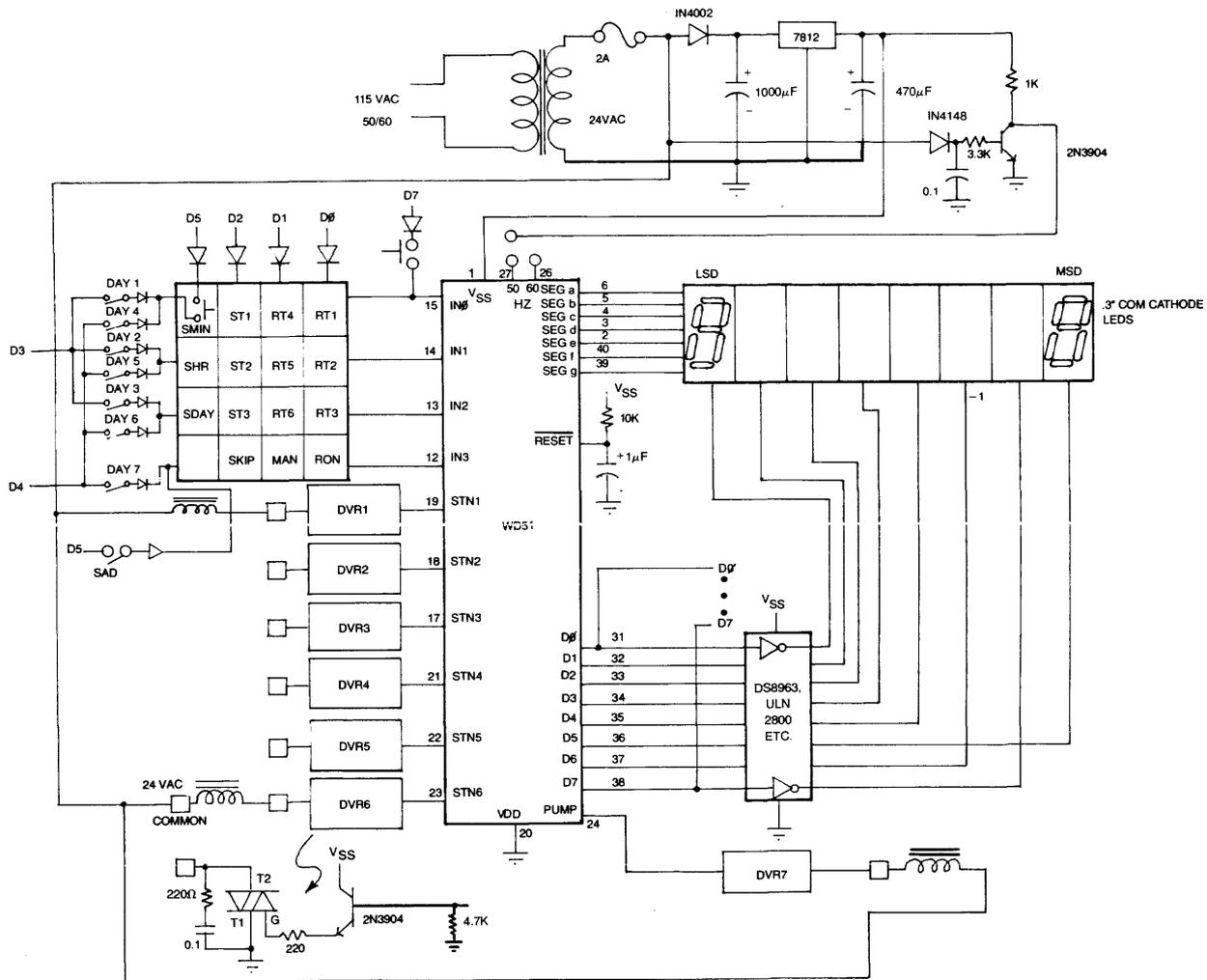
FIGURE 5 COMPLETE 6-STATION IRRIGATION CONTROLLER
