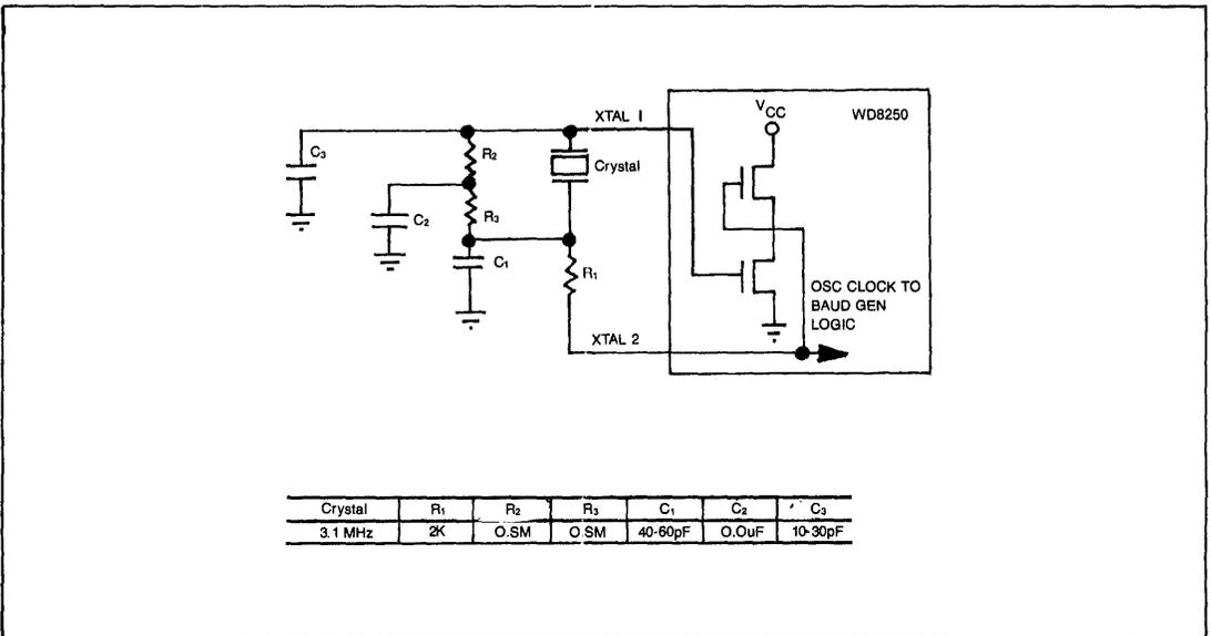
FIGURE 4. TYPICAL CRYSTAL OSCILLATOR NETWORK
