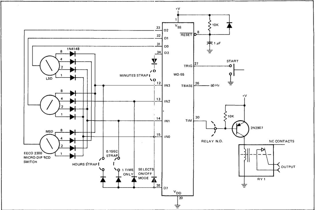
**FIGURE 6. DIGITAL TIME DELAY RELAY**
