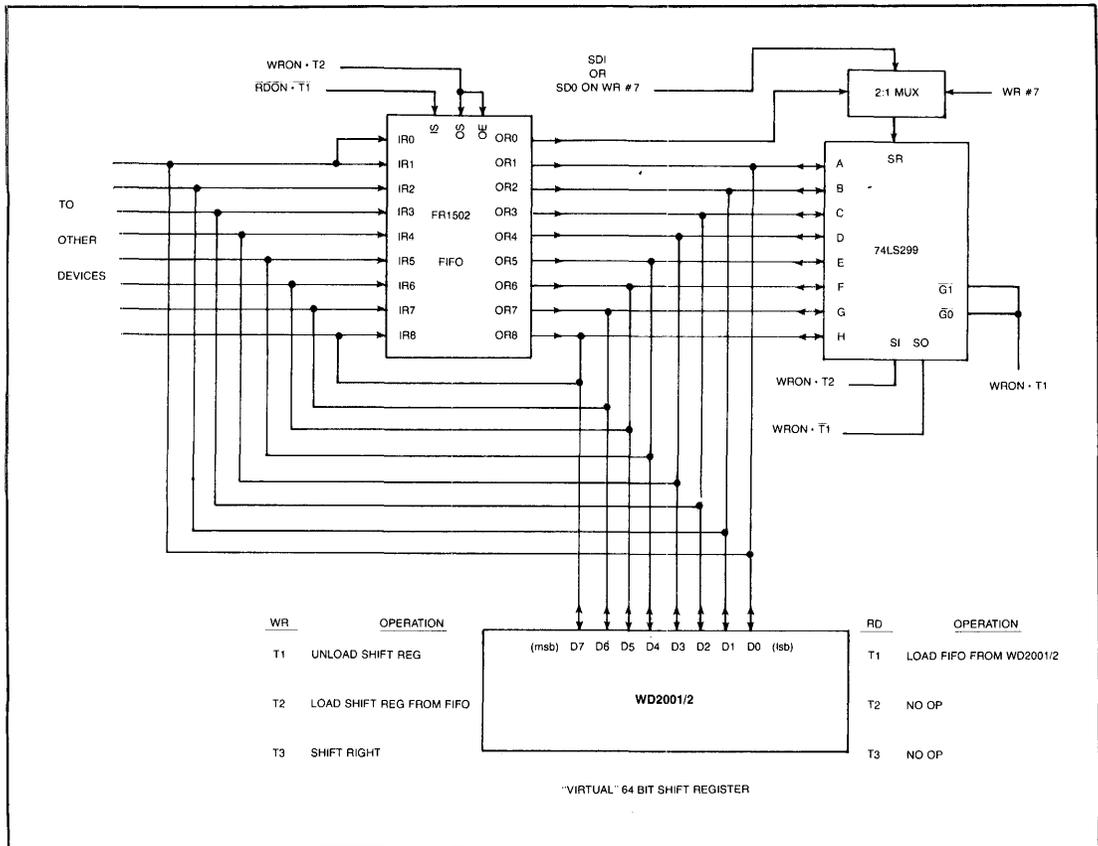
**Figure 13 "VIRTUAL" 64 BIT SHIFT REGISTER**
