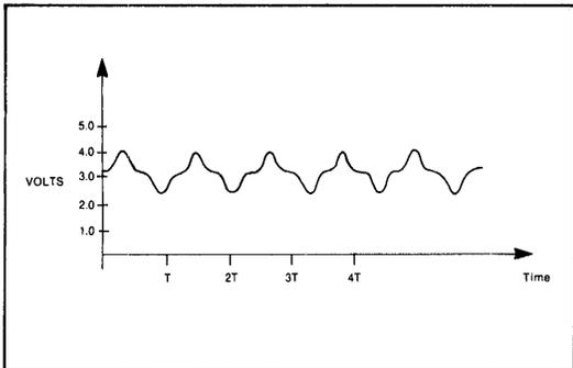
Figure 1 TYPICAL CRYSTAL WAVEFORM
