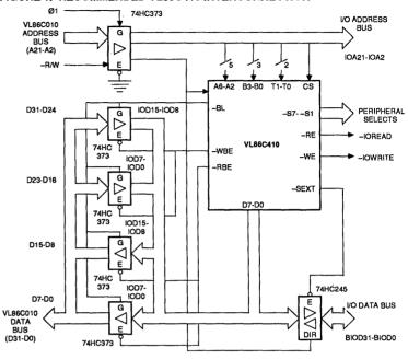
FIGURE 2. TYPICAL DECODING STRUCTURE
