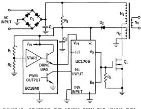
FIGURE 15- POWERING THE UC1706 FROM THE UC1840 PWM CONTROLLER
