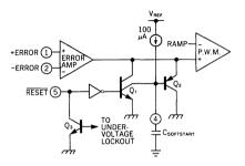
Figure 3. Soft-Start Circuit Schematic
