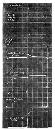
FIGURE 26- BIPOLAR SQUARE WAVE GENERATOR WAVEFORMS
