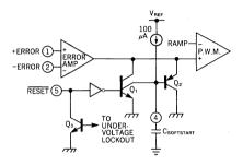
Figure 3. Soft-Start Circuit Schematic
