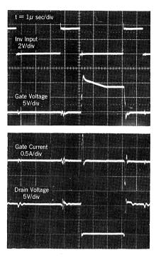
FIGURE 19- DIRECT DRIVE TURN-ON WITH EXPANDED TIME SCALE
