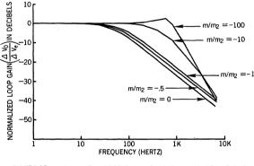
FIGURE 13 - NORMALIZED LOOP GAIN V.S. FREQUENCY FOR VARIOUS SLOPE COMPENSATION RATIO'S.
