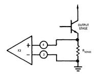
A.) RESISTIVE SENSING WITH GROUND REFERENCE
