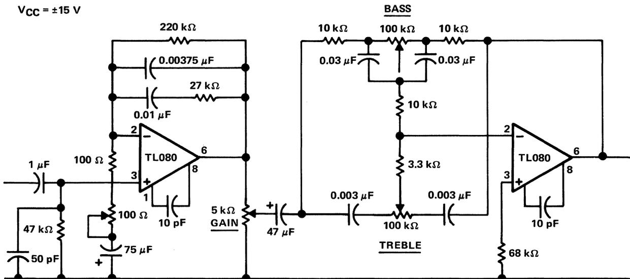
Figure 3-28. IC Preamplifier
