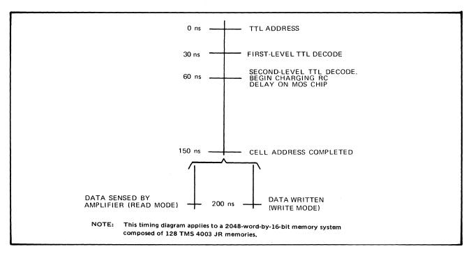
FIGURE 2 - TYPICAL SYSTEM CYCLE TIME
