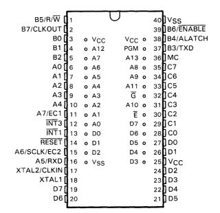
Figure 2-7. TMS7742 Pinout
