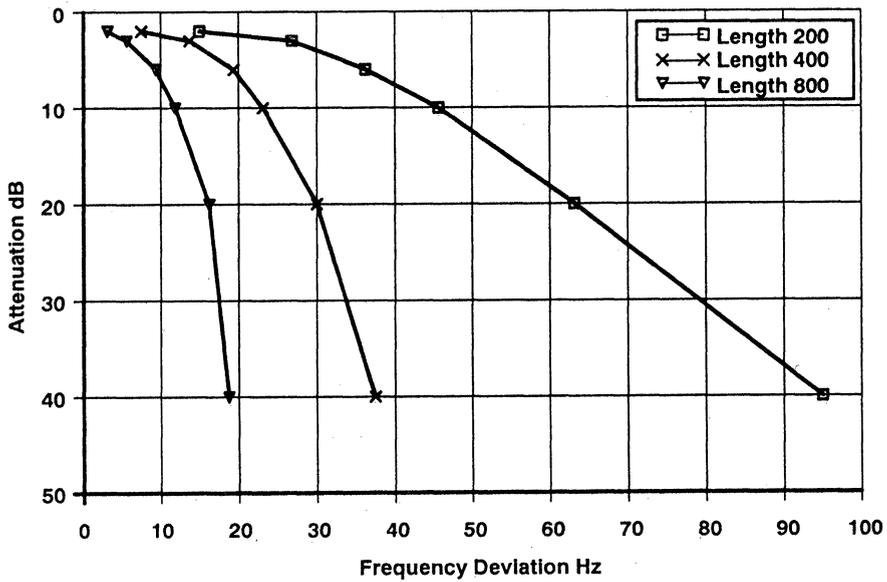
Figure 22. Filter Band Edge Shape - Narrow Filter
