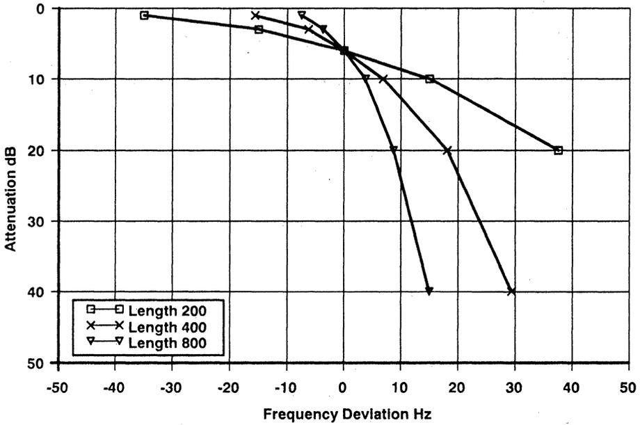
Figure 21. Filter Band Edge Shape - Wide Filter
