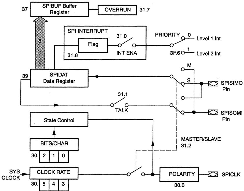
**Figure 7. TMS370C010 SPI Module**
