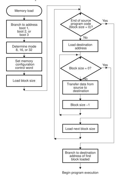
Figure 11-2.Boot-Loader Memory-Load Flowchart
