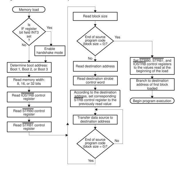
Figure 11-6.Boot-Loader Memory-Load Flowchart
