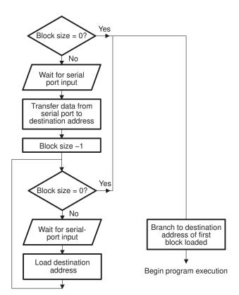
Figure 11-3.Boot-Loader Serial-Port Load-Mode Flowchart
