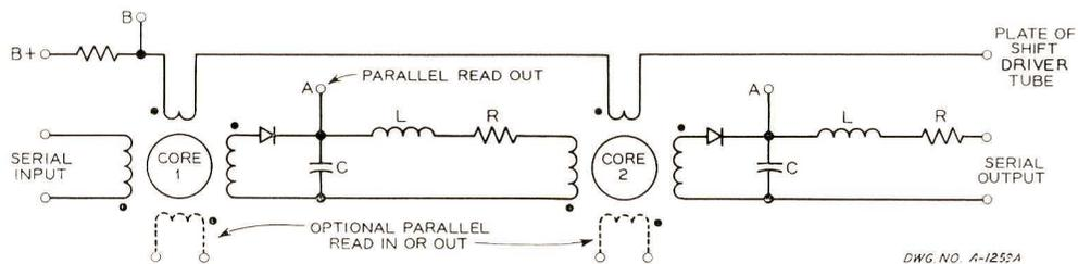
GENERAL CIRCUIT FOR CORE-DIODE TYPE MAGNETIC SHIFT REGISTERS
