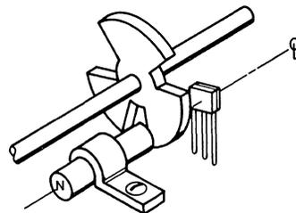
B. FERROUS VANE ROTOR
