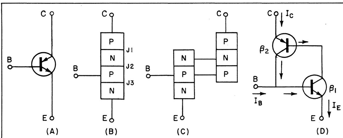
Fig. 2 Trigistor Equivalent Circuits
