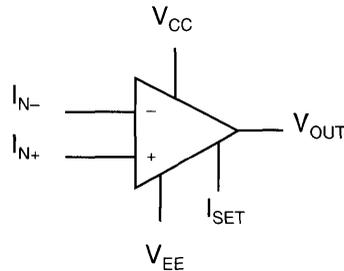
$V_{CC}$  POSITIVE POWER SUPPLY
