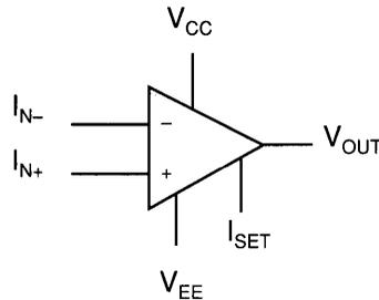
$V_{CC}$  POSITIVE POWER SUPPLY
