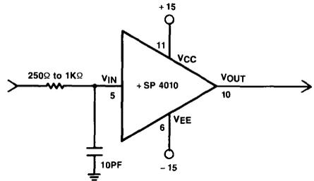
OPTIMIZE FOR LARGE SIGNAL SETTLING
