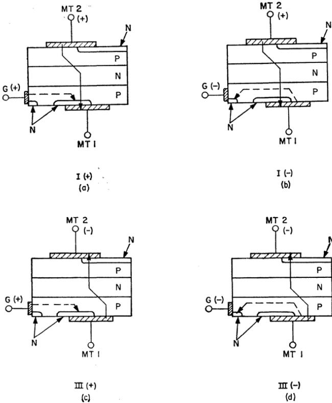
Figure 27. Current flow in the four triggering modes of a triac: (a) Mode I(+); (b) Mode I(-); (c) Mode III(+); (d) Mode III(-).
