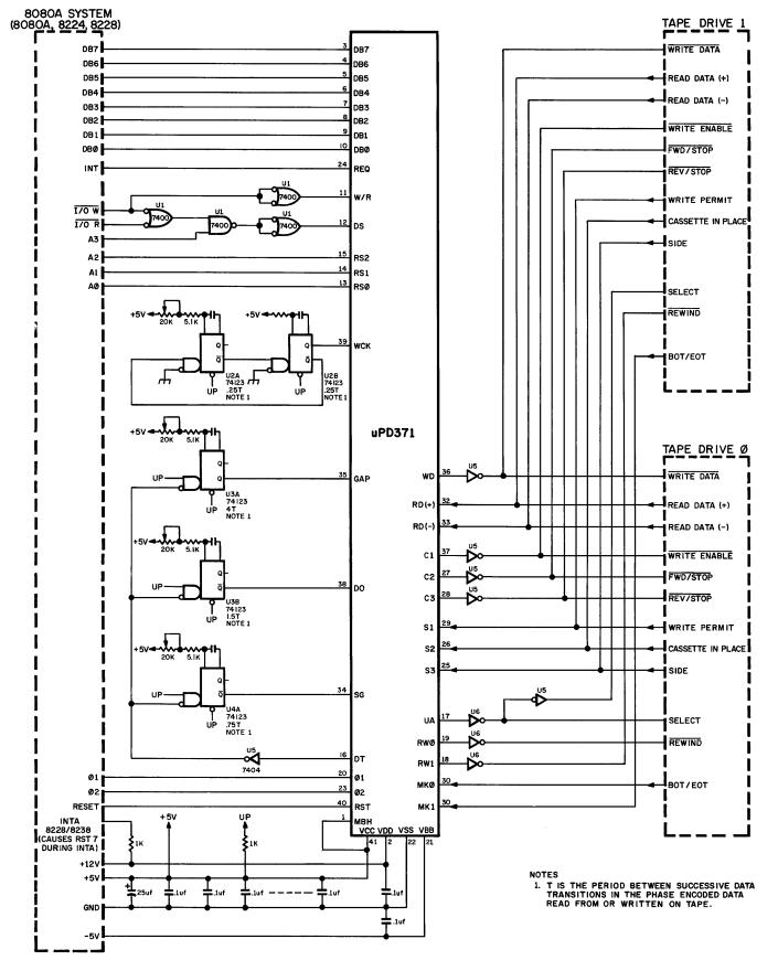
FIGURE 11 uPD371 DUAL TAPE CASSETTE/CARTRIDGE CONTROLLER EXAMPLE
