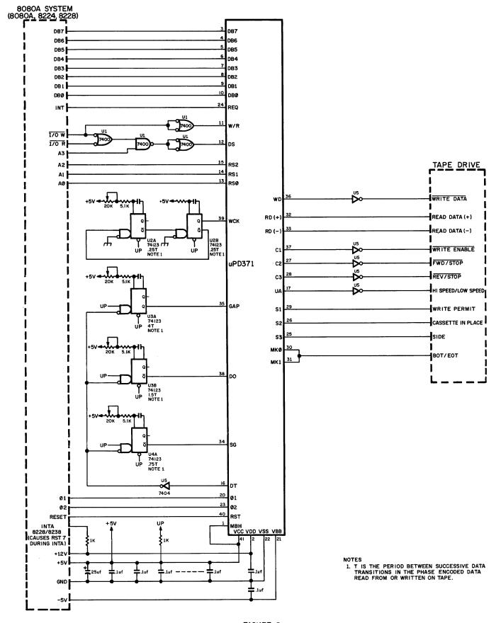
FIGURE 8 uPD371 TAPE CASSETTE/CARTRIDGE CONTROLLER EXAMPLE
