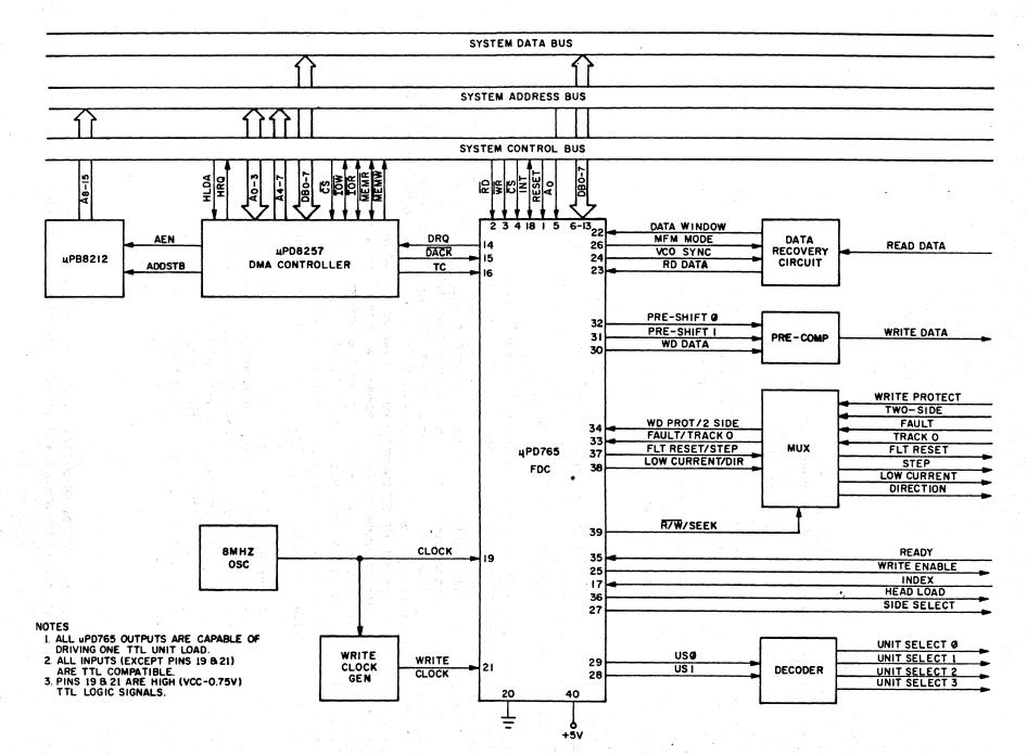
FIGURE 1 SYSTEM BLOCK DIAGRAM OF A FLOPPY DISK CONTROLLER
