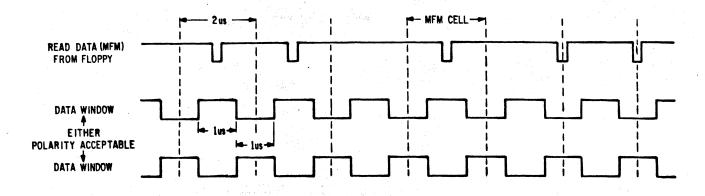
FIGURE 12 DATA WINDOW SIGNAL REQUIRED BY uPD765
