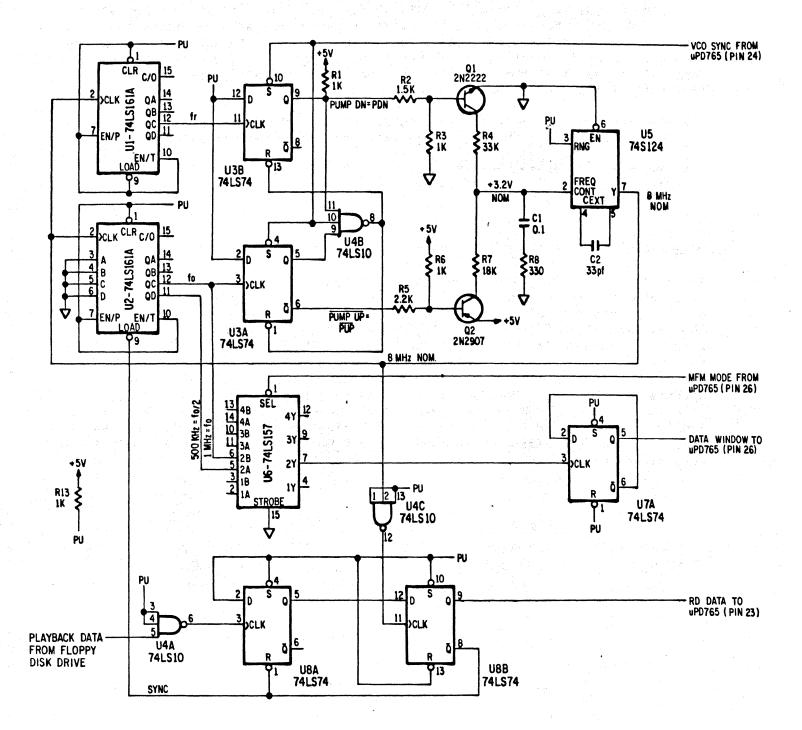
FIGURE 13 PHASE LOCKED LOOP FOR FM/MFM ENCODED DATA
