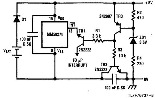
**FIGURE 7. 5V Isolation Circuit**
