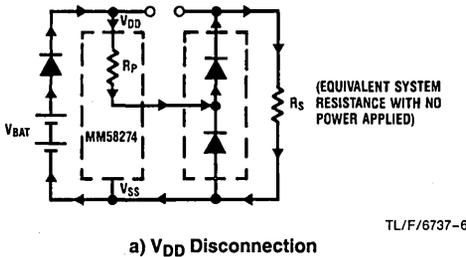
**a)  $V_{DD}$  Disconnection**
