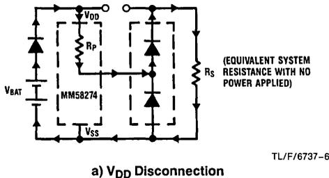
**a)  $V_{DD}$  Disconnection**
