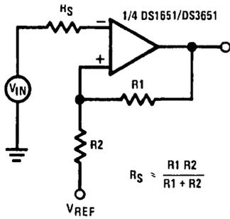
$$R_S \approx \frac{R_1 R_2}{R_1 + R_2}$$
