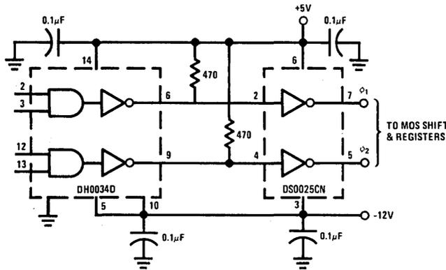
FIGURE 15. DC Coupled Clock Driver Using DH0034
