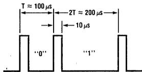
Figure 4. Pulse-Position-Modulation (PPM) Timing
